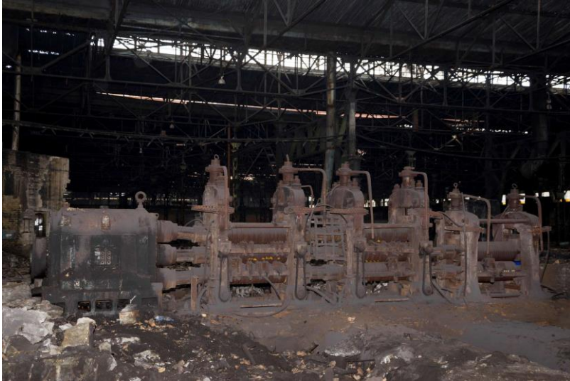
Finomhengerműi központi hengerállvány hengerekkel, alaplappal
